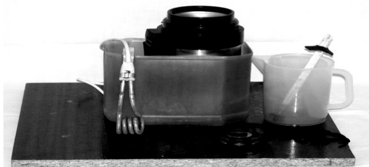
Рис. 8.1. Лабораторная установка для определения удельной теплоемкости и удельной теплоты парообразования воды
