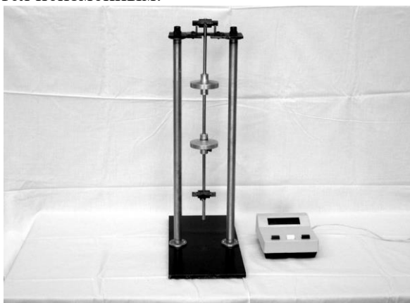
Рис. 5.3. Установка для определения ускорения свободного падения методом оборотного маятника
