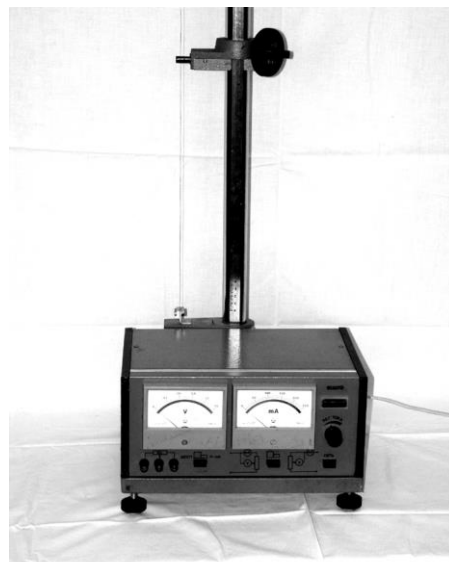
Рис. 9.1. Установка для измерения удельного сопротивления тонкого провода
