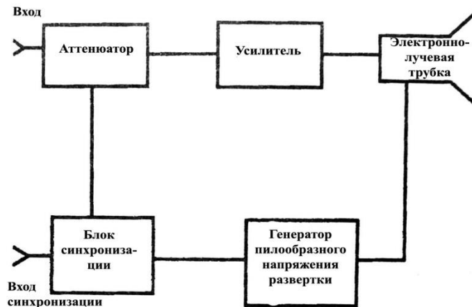
Рис. 2.5. Блок-схема осциллографа
